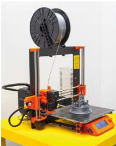
Rys. 2.5. Drukarka 3D w trakcie pracy
